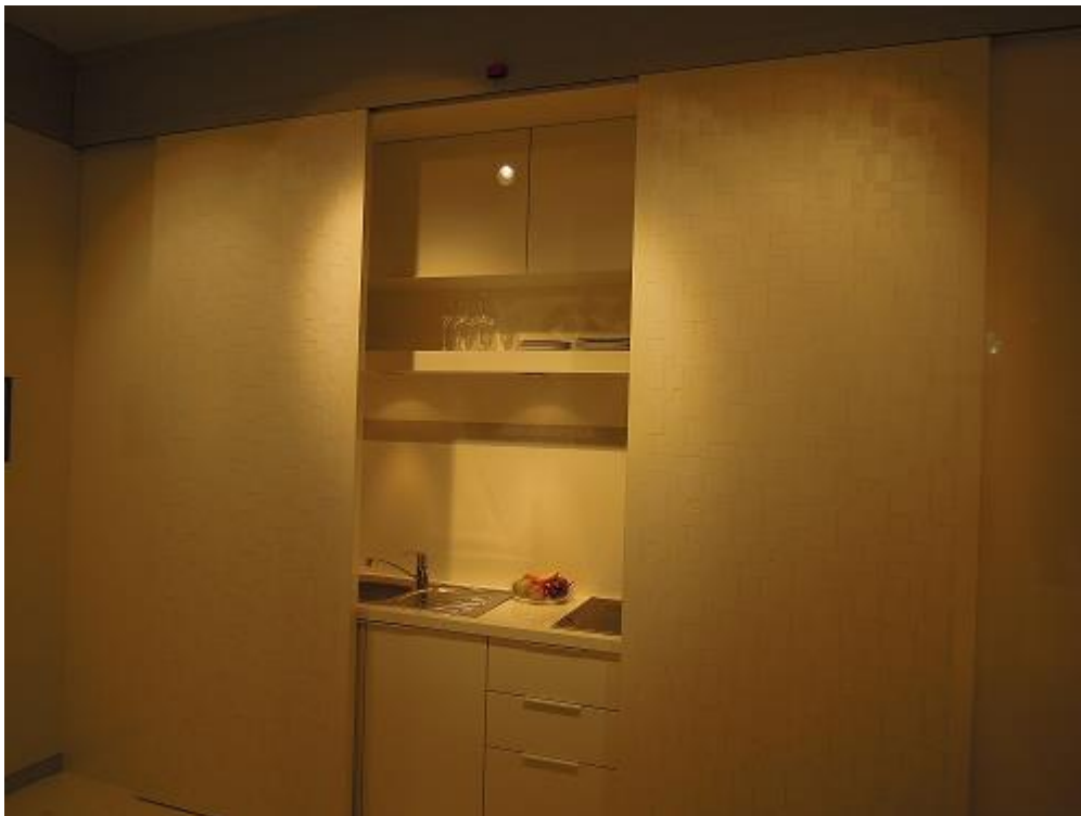
סגירת מטבחון באמצעות שתי מערכות MAGNEO (המנגנון סמוי בתוך התקרה)
